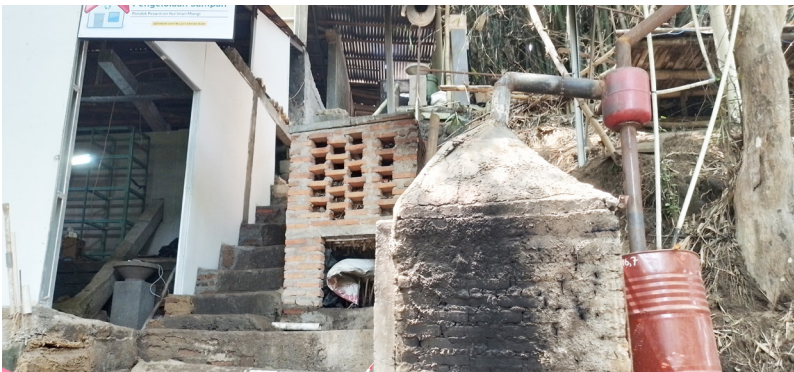
Alat Pembakaran Sampah : inovasi dari Pondok pesantren Mlangi berupa alat pembakaran sampah yang minim asap.
